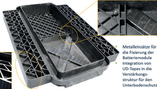
Abb. 3: Demonstrationsbauteil „Batteriegehäuse“, bestehend aus glasfaserverstärktem Polyamid 6 (LFT) mit thermoplastischer Endlosglasfaserverstärkung (UD-Tape-Strukturen und Organoblech) und metallischen Funktionselementen, hergestellt im D-LFT Fließpressverfahren
